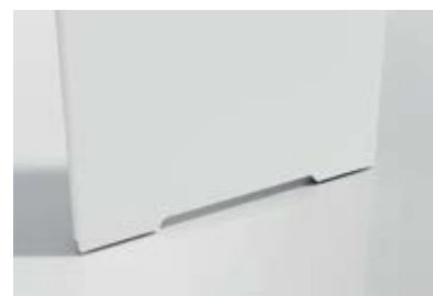
VENTILAȚIA SUBDECUPATĂ ÎN UȘILE PANOULUI 1 undercut 15 mm - pentru camere cu recuperare degajare 26 mm - WC pentru uși 80'-100' degajare 38 mm - WC pentru uși 60'-70'
